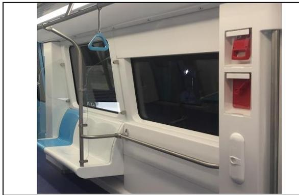
圖 22 車內滑門緊急試壓閥及車門開啟裝置
