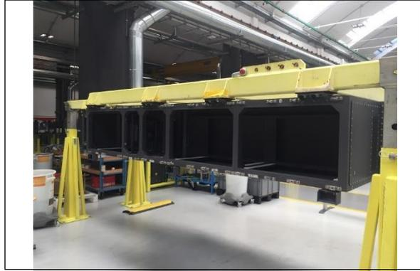
圖 35 三鶯線動力機箱外殼
