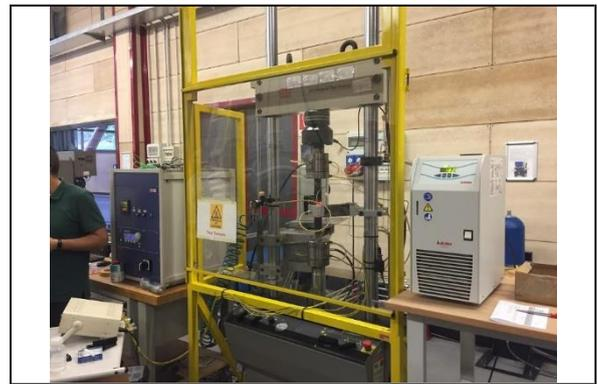
圖 57 含溫控拉伸試驗機
