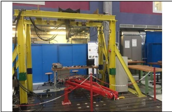
圖 56 集電弓特性測試設備
