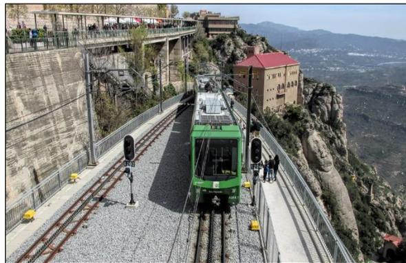
圖 84 登山鐵路列車採集電弓供電及設備
