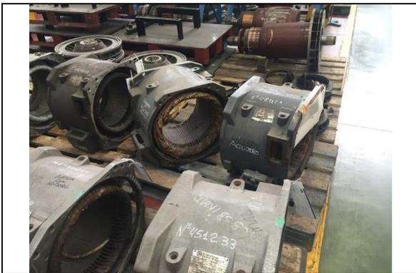
圖 95 發電機感應電圈整修品
